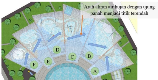
Gambar 28. Detail kemiringan atap water park indoor dewasa
