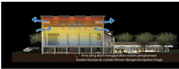
Gambar 8. Skema sistem kenyamanan termal pada hall utama
