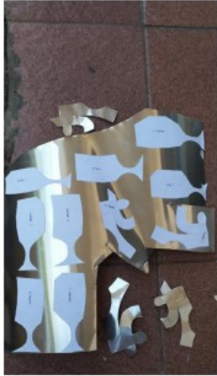
Gambar 3.2 Proses Pemotongan Almunium Perbagian Jari
