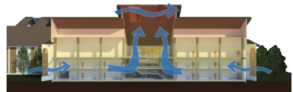
Gambar 6. Skema sistem kenyamanan termal pada asrama (ruang bersama)
