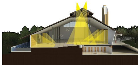
Gambar 5. Skema pencahayaan alami pada masjid
