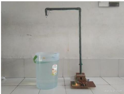
Gambar 3.1 Pengujian Sensor Ultrasonik sebagai Pengukur Ketinggian air
