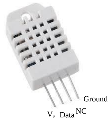
Gambar 4. Konfigurasi Kaki DHT22
