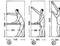
Gambar 8. Pengukuran dan Kebutuhan Rak Hidroponik
