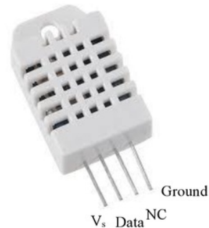
Gambar 4. Konfigurasi Kaki DHT22
