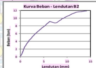
Gambar 11. Kurva Hubungan Beban dan Lendutan Balok Uji B2
