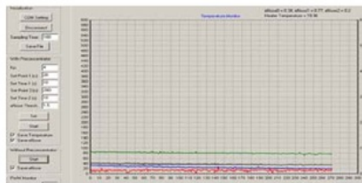
Gambar 8. Respon Sensor Terhadap Udara Kering
