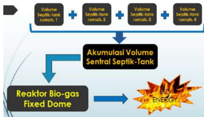
Gambar. 4.1. Diagram Blok Sistem Instalasi Pipa Septik-Tank Tersentralisasi
